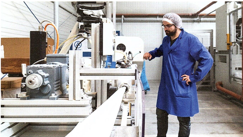
Ein Mitarbeiter von McAirLaid kontrolliert die Herstellung der Zigarettenfilter. Bild: McAirLaid
