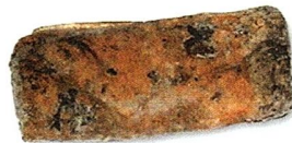
Der Standard-Zelluloseacetatfilter nach einer Woche. Bild: McAirLaid
